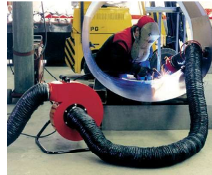
Flytbar ventilator, der anvendes med en magnetisk sugehoved ved svejseproces
