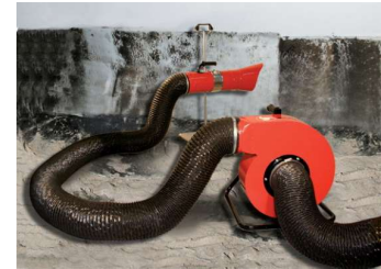
Flytbar ventilator anvendt ved udtørring af væg
