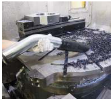
Afsugning af metalspåner fra bearbejdningscenter.
